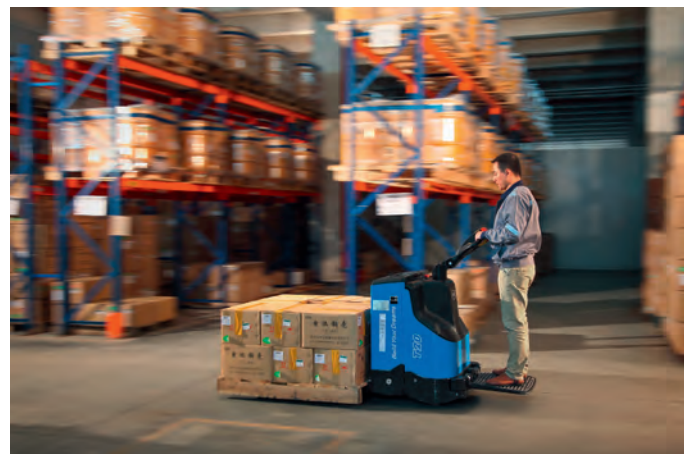
Einige der elektrischen Deichselhubwagen sind mit einer klappbaren Mitfahrplattform ausgestattet.
